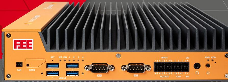
Die neue „emulation.box“ von F.EE emuliert die PROFINET-Teilnehmer der speicherprogrammierbaren Steuerung, so dass diese – einschließlich Safety-Signalen – für die SPS im Netzwerk verfügbar sind. Angebundene Steuerungen können so einfach und identisch zu realen Feldbusteilnehmern betrieben werden. Damit wird sowohl eine **Kopplung an reale Steuerungen** als auch ein **Mischbetrieb von realen und virtuellen Geräten** bei der Anlagensimulation mit „fe.screen-sim“ ermöglicht.
